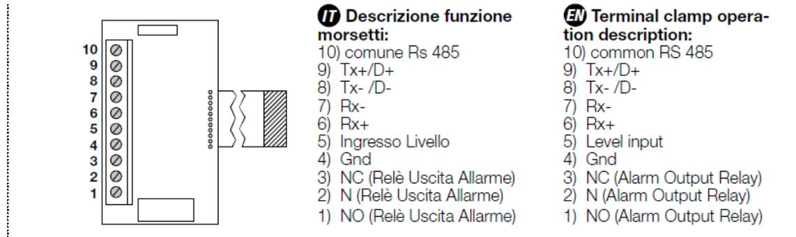
b) iesirea semnalului de alarma : semnaleaza o eventuala oprire din cauza unei defectiuni. Semnalul poate fi conectat atat la NC cat si la NO. Sarcina maxima conectata e 5 A la 250 VAC;sunt contactetoarele indicate la pozitiile 1, 2 si 3.
