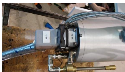
Figura 5b - DTC cameră termografică stânga
