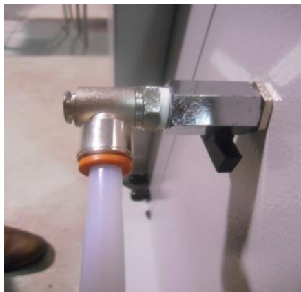
Figura 7 – Conexiunea pneumatică laterală din partea dreaptă a DTC
